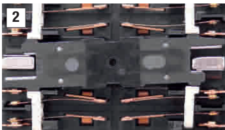
Sicherheitsrelais SF4D im erregten Zustand.
