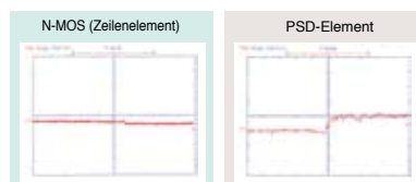
Messwertänderung beim Übergang von weißer Keramik auf schwarzen Gummi
